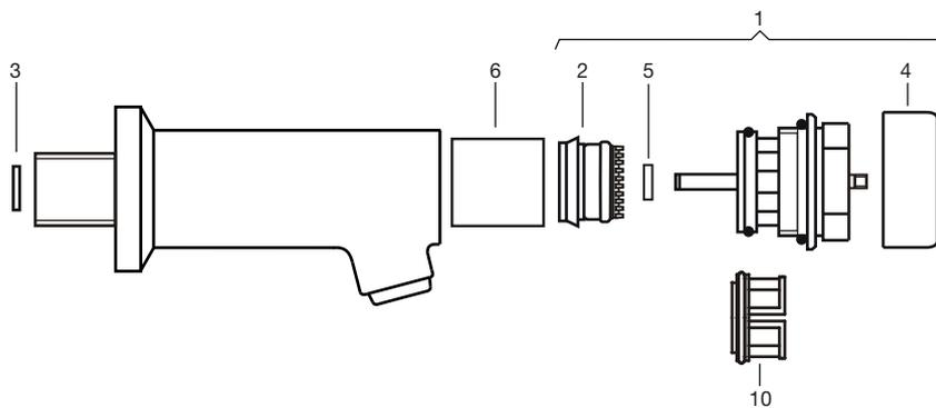
**Art. 0362 Válvula para descarga de mingitorio, automática** *(Para mingitorio tipo tria de Ferrum S.A.)*
