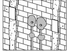
Asegure las cañerías con cemento. Retire la plantilla y cimente los codos.
