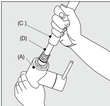
4\_ Por debajo de la mesada posicione la arandela de goma, la arandela metálica y enroscando la tuerca.
