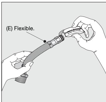
8\_ Conecte los flexibles (E) para el agua fría y caliente a las conexiones del juego y a la pared.
