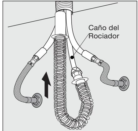
12\_ Desplace el rociador hacia abajo, para utilizarlo fuera del pico. Presione el gatillo para cambiar el tipo de salida de agua, y utilizar el modo rociador.
