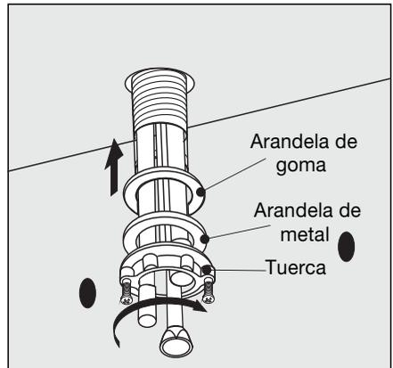
5\_ Ajuste los tornillos provistos en la tuerca de fijación del pico, con un destornillador phillips.
