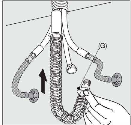
11\_ Conecte la manguera del rociador al caño de entrada de agua , prestando atención que la junta sello esté en su lugar. Finalmente verifique que no existan pérdidas de agua en las conexiones realizadas.
