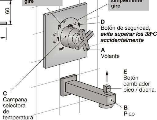
Al girar el volante 'A' obtendrá agua a través del pico 'B'. Si desea obtener salida de agua por la ducha, tire del botón 'E'. Para seleccionar la temperatura deseada utilice la campana 'C'. Para obtener temperaturas superiores a 38°C debe presionar el botón 'D' y girar la campana hacia la izquierda. Para temperaturas inferiores solamente gire la campana hacia la derecha.
