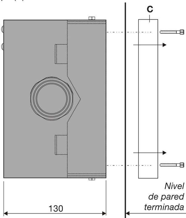
4\_ Luego regule el marco (E) hasta enrasarlo con el nivel de pared final. Ajustelo desde el interior, con los 4 tornillos laterales (F) y empastine todo el perímetro.
