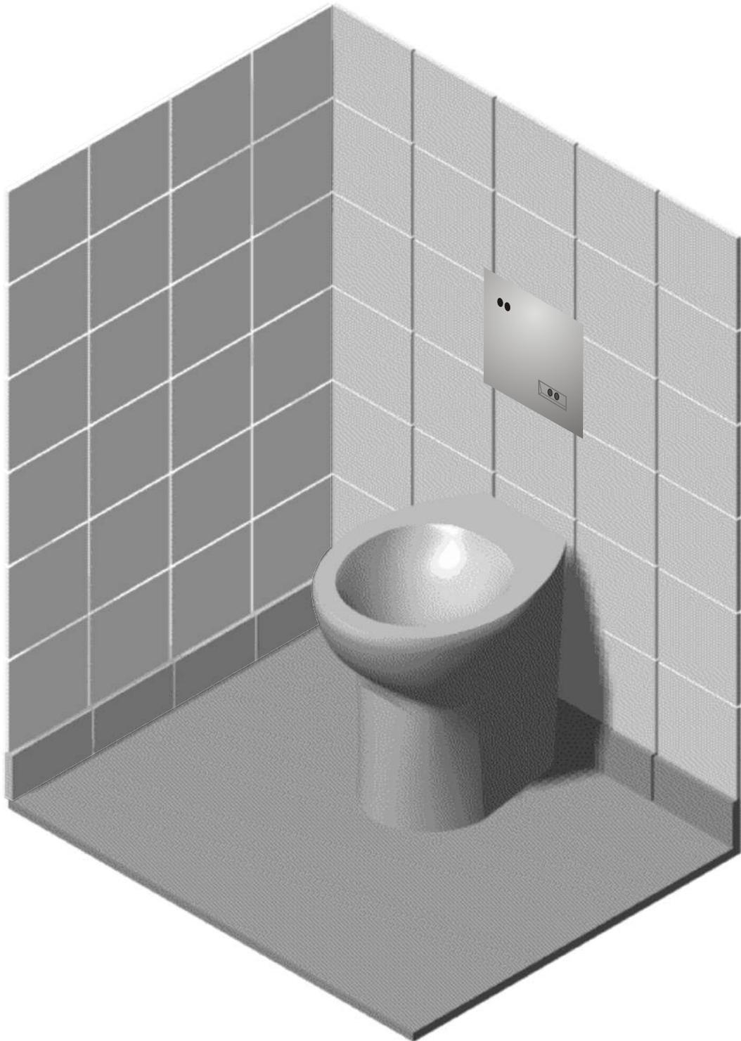
3\_ Realice el revestimiento previsto y, una vez finalizado, retire y descarte los tornillos y la tapa (C).
