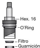
1\_ Retire la cabeza utilizando una llave de boca 16 mm y verifique si el filtro está tapado.
