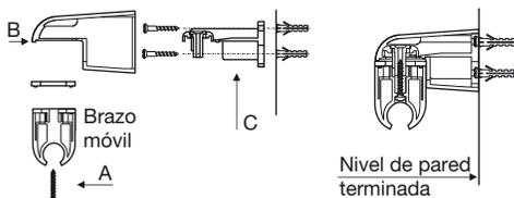
1\_ Retire el tornillo A y desmonte el brazo móvil.
