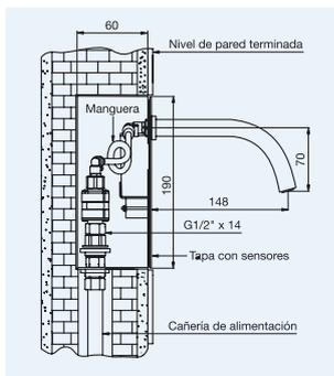
**0375.02** - Válvula electrónica para descarga lavatorio con tapa de acero inoxidable.
