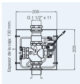
**0366.FVBASE** - Válvula electrónica para descarga de inodoro para embutir.
