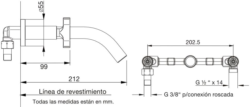
Es muy importante saber de antemano cual va a ser el revestimiento que se va a usar. También es importante no soldar cerca del esqueleto, porque esto puede llegar a dañar el mecanismo de las cabezas, o provocar fisuras en los esqueletos con la consiguiente pérdida de agua dentro de la pared.
