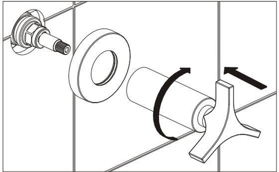
3\_Coloque primero el suplemento plástico y después posicione la roseta metálica. Por ultimo enrosque el pico salida. Este paso solo será aplicable para los juegos 103/C3.
