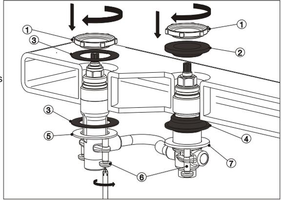
2\_ Para el armado de la sopapa lavatorio, desarme el conjunto y coloque la rejilla (B) en la parte de arriba sobre el agujero de desagüe del lavatorio, mientras que el O'ring (C) ira colocado debajo entre el lavatorio y el cuerpo de la sopapa (D).
