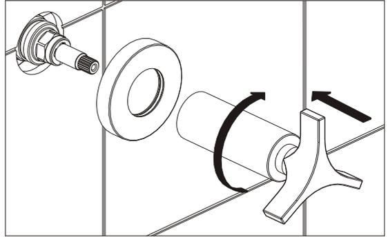
2\_ Coloque primero el suplemento plástico de color blanco y después posicione la roseta metálica. Por ultimo enrosque el pico salida.
