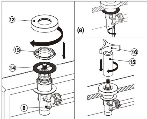
4\_Para el armado del volante, primero coloque la roseta (12), luego posicione el volante (16) verificando que quede en correcta posición y por ultimo rosque el cuerpo del volante (15) a la llave (6)
