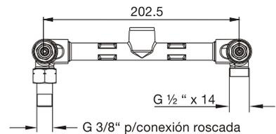
Cuando ubique la grifería en la pared preste especial atención a las medidas máximas y mínimas y a la medida de conexión de entradas y salidas.
