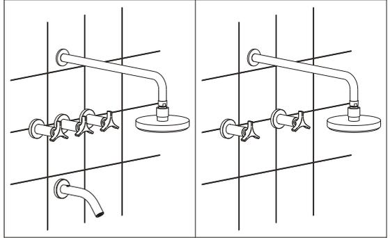
2\_Coloque la roseta deslizando por el volante, inserte el mismo en el esqueleto verificando que quede en la posición deseada y gire la parte inferior del volante en sentido horario para rosca al esqueleto hasta ajustar. Por ultimo, deslizar la roseta hasta hacer contacto contra la pared.
