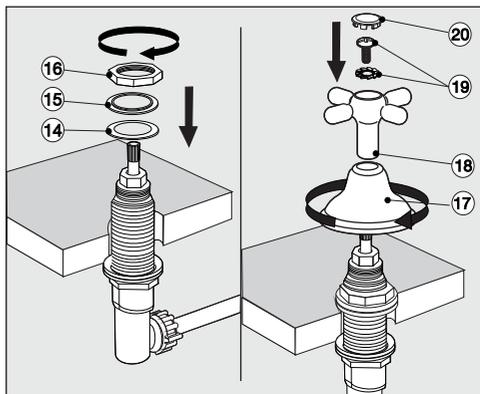
4\_ Enrosque la rosca (17), posicione el volante (18) y ajuste el tornillo con la arandela aletada (19) y finalmente coloque la letra decorativa (20) presionandola suavemente.
