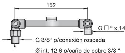
Cuando ubique la grifería en la pared preste especial atención a las medidas máximas y mínimas y a la medida de conexión de entradas y salidas.
