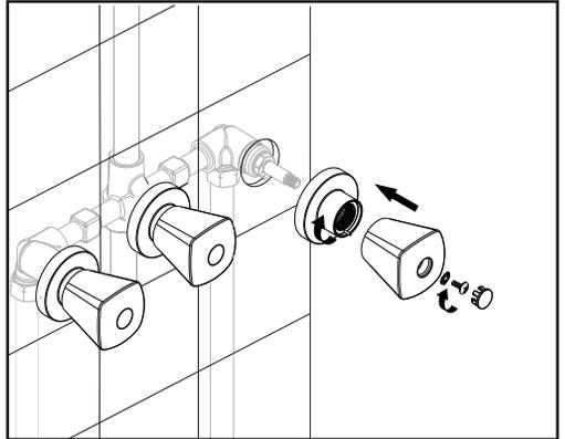
3\_ Para la instalación del pico salida, primero deberá colocar el refuerzo plástico y después la roseta metálica. Por ultimo enrosque el pico salida.
