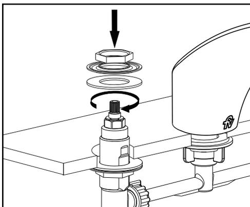
3\_ Enrosque la roseta y coloque el volante, utilice el tornillo y la arandela metálica para fijar este conjunto. Por ultimo coloque la letra de decorativa.
