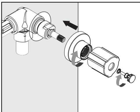
2. Coloque la roseta en el codo de conexión, luego enrosquelo en la salida del esqueleto.
