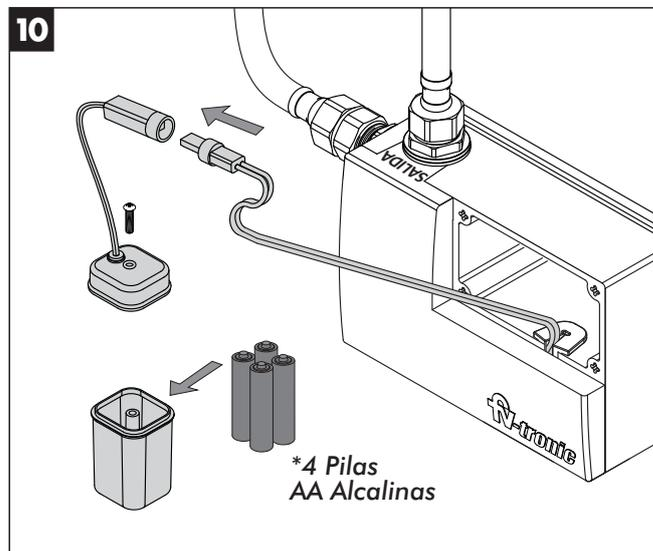
10 Colocar las 4 pilas AA alcalinas (\*no provistas) en el portapilas y conectar los cables y reubicar dentro de la caja.
