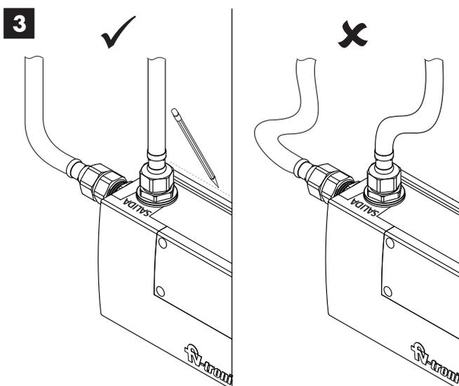
Presentar y marcar la posición de la caja de forma tal que los flexibles no sean estrangulados. Una vez marcada la posición quitar los flexibles.
