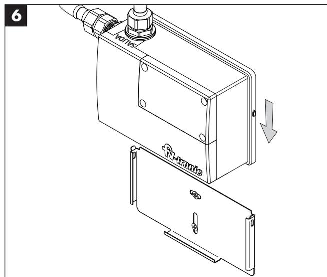
6 Deslizar la caja sobre las guías del soporte previamente instalado.
