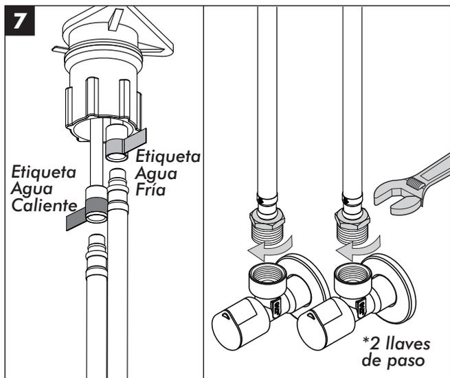
7 Colocar los flexibles (400mm M-M) a los caños de agua etiquetados (Agua fría-Agua Caliente) y a las llaves de paso (provistas) y ajustar.
