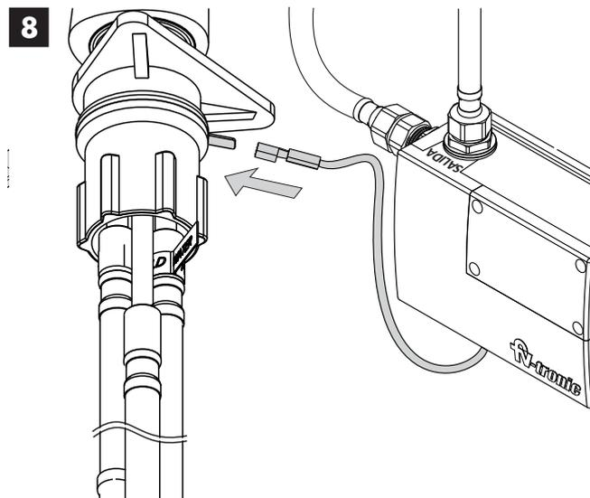
8 Conectar la ficha de la caja plástica a la arandela de conexión. Verificar que la ficha no quede en contacto con la bacha metálica
