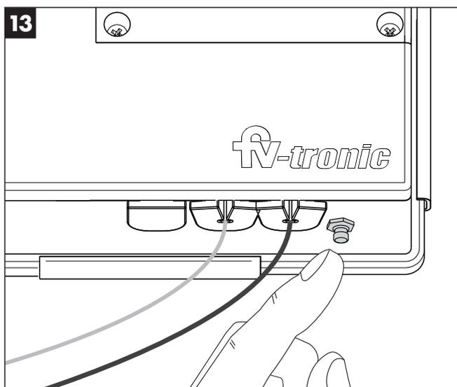
Resetear el juego presionado el boton en la caja plástica, y esperar 5 segundos aprox. hasta la primera expulsión de agua.
