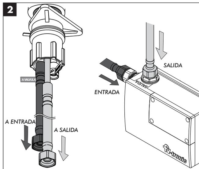
Conectar el flexible (600mm) al caño etiquetado (a válvula) y luego a la -ENTRADA- de la caja. Conectar el otro flexible (600mm) al caño no etiquetado con la -SALIDA- de la caja.
