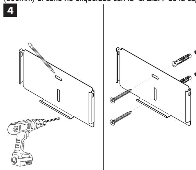
Marcar los orificios del soporte de la caja. Perforar para colocar tarugos y fijar con los tornillos provistos.
