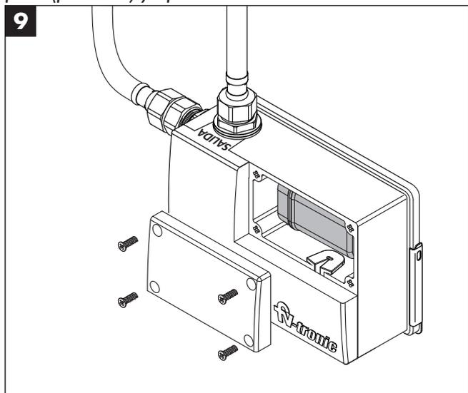
9 Retirar la tapa del portapilas quitando los tornillos y remover el portapilas.
