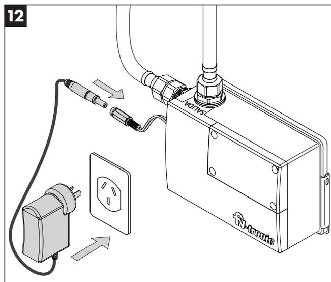
Conectar el plug del transformador al correspondiente en la caja plástica y luego a la red electrica. (Recomendación: tener un toma de alimentación cerca de la bacha de cocina)
