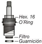
1\_ Retire la cabeza utilizando una llave de boca 16 mm y verifique si el filtro está tapado.
