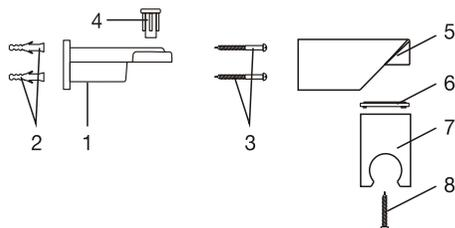
**A\_** Fijar el soporte (1) a la pared, utilizando los tarugos (2) y los tornillos (3).
