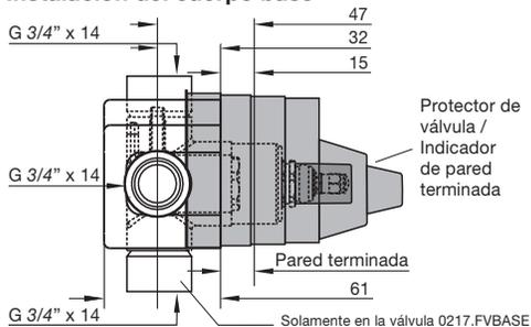
**Una vez verificada la estanqueidad del circuito y colocado el revestimiento final (ver folleto correspondiente al art. 0217.FVBASE):**
