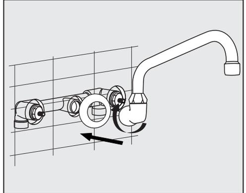
2\_ Para instalar los volantes, enrosque primero la roseta en el esqueleto, luego coloque el buje hexagonal en las ranuras del vástago del esqueleto, y sobre este último ubique el cuerpo del volante. Para ajustarlo debe enroscar el tornillo con la arandela al esqueleto como se indica en la figura. Por último coloque la letra decorativa presionandola.
