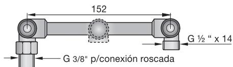
Cuando ubique la grifería en la pared preste especial atención a las medidas máximas y mínimas y a la medida de conexión de entradas y salidas.
