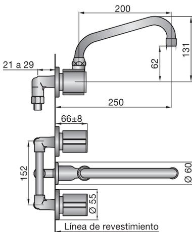
Es muy importante saber de antemano cual va a ser el revestimiento que se va a usar. También es importante no soldar cerca del esqueleto, porque esto puede llegar a dañar el mecanismo de las cabezas, o provocar fisuras en los esqueletos con la consiguiente pérdida de agua dentro de la pared.
