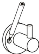
1\_ Use el soporte ( en la posición que indica la figura) para marcar el lugar donde se realizará el primer agujero para la fijación del mismo.
