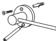
6\_Perfore sobre las marcas restantes de ambos soportes y fíjelos con los tarugos y tornillos provistos.
