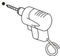
2\_ Realice el agujero con una mecha diámetro 6 mm y coloque el tarugo plástico.
