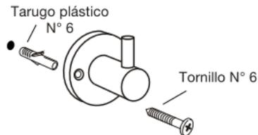
3\_ Fije el soporte en la pared con uno de los tarugos plásticos y tornillos provistos con el juego. Luego realice el segundo agujero y fije el tornillo restante.
