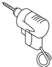
2\_ Realice el agujero con una mecha diámetro 6 mm y coloque el tarugo plástico.
