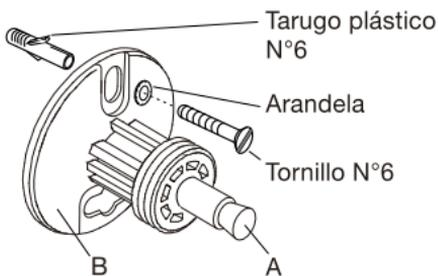
3\_ Ubique el prolongador (A) a través del soporte (B) y fíjelo a la pared colocando la arandela y el tornillo. Marque el segundo agujero, haga la perforación y coloque el otro tarugo. Luego con la arandela y el tornillo restante fije el soporte definitivamente.
