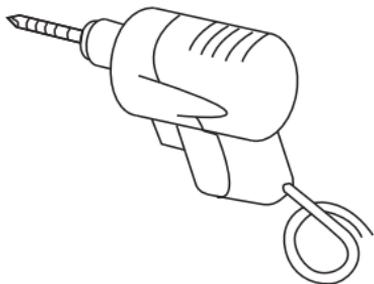
2\_ Realice el agujero con una mecha diámetro 8 mm y coloque el tarugo plástico.
