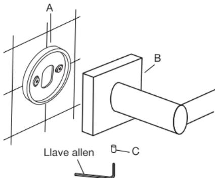
d\_Ubique el accesorio sobre ambos soportes "A", manteniendo presionado todo el conjunto sobre la pared. Ajuste el prisionero "C" de cada roseta "B" a cada soporte "A" con la llave Allen provista con el juego.
