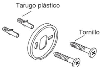
3\_Fije el soporte a la pared mediante los tarugos plásticos y los tornillos provistos con el juego. Repita el procedimiento (pasos 1 y 2) para completar la fijación del mismo.
