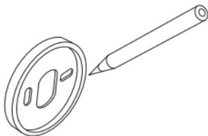
1\_ Use un soporte (en la posición que indica la figura) para marcar el lugar donde se realizará el primer agujero para la fijación del mismo.
