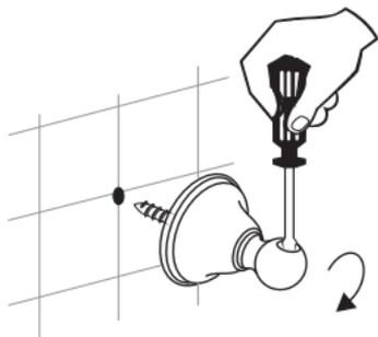
5\_ Ubique el accesorio en el tarugo y luego gire el mismo en sentido horario con un destornillador o elemento similar hasta hacer tope en la pared.
