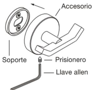
4\_ **Ajuste** el accesorio sobre el soporte, como muestra el dibujo.
