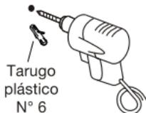
2\_ **Perfore** con una mecha  $\varnothing$  6 mm.
