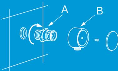
Enrosque el adaptador (A), luego coloque la campana (B) deslizándola sobre el adaptador (A). Fije la campana (B) con el tornillo, luego coloque la tapa a presión sobre el conjunto. Screw the adaptor (A) then put escutcheon (B) and push it on the adaptor (A). Then use bolt to fix the escutcheon. Finally put the cap on the set.
