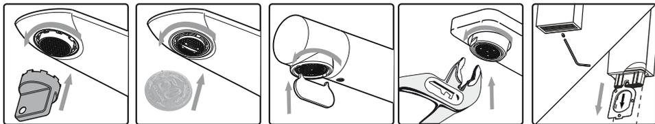
Coloque la herramienta correspondiente según el tipo de aireador y remuévalo del pico. Lávelo bajo un chorro de agua. Si esta tapado colóquelo en un vaso de vinagre durante la noche. Al día siguiente vuelva a armarlo.
