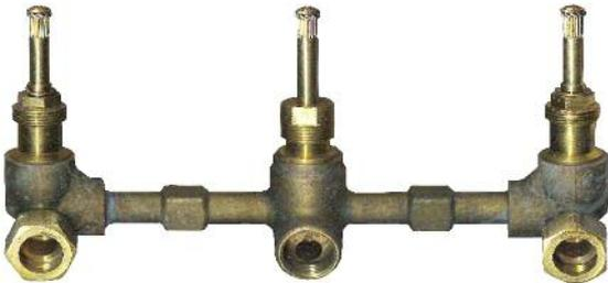
**Esqueleto de vástago no ascendente, con valvulita (fig. 3)** con cabezas con mecanismo de vástago no ascendente. Rosca de 1/2" x 19. Juegos con mecanismo de vástago no ascendente, doble o'ring y cámara de grasa. Se utiliza en las líneas 15, 16 y 17.
