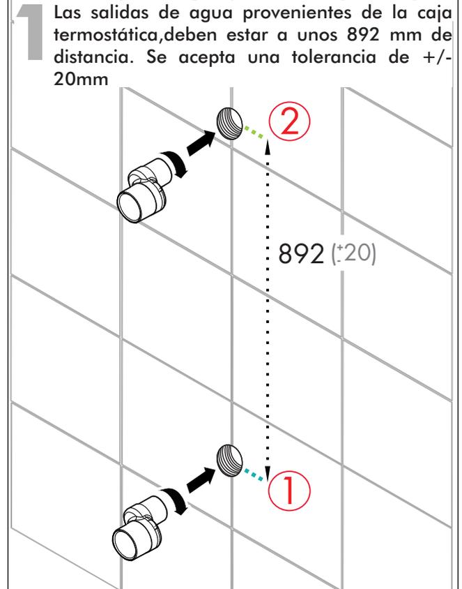
**2** Enrosque los tubos excéntricos. Estos absorberán la tolerancia de +/- 20mm.
