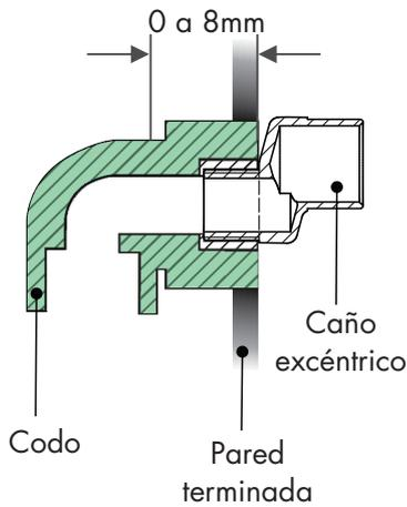
La cara visible del codo puede estar de 0 a 8 mm por detrás del nivel de la pared terminada.
