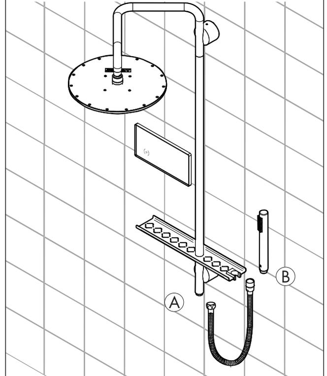
**10** Para finalizar, coloque la ducha de mano (A) en el soporte y active el display (B) previamente instalado.
