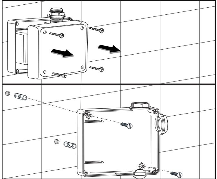
Para la fijación deberá realizar dos agujeros en la pared de  $\varnothing 6$ , luego deberá introducir los tarugos y por ultimo fijar la caja con los tornillos, ambos provisto en el pack.
