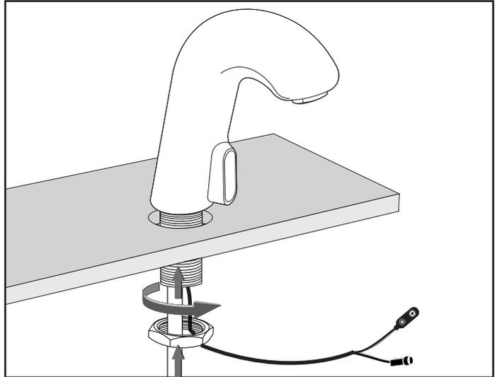
2. Conecte los flexibles para el pasaje de agua, según el sentido indicado.
