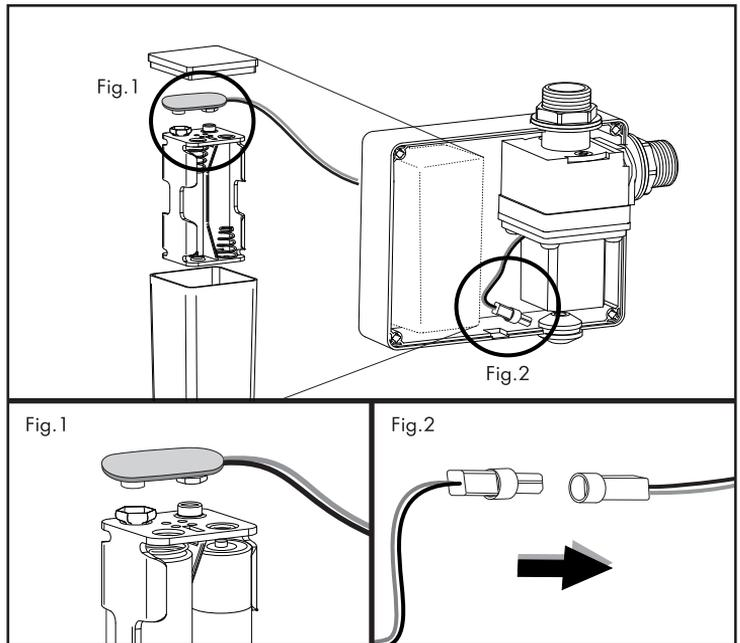
Fig. 1: Conecte la alimentación del porta pilas.
