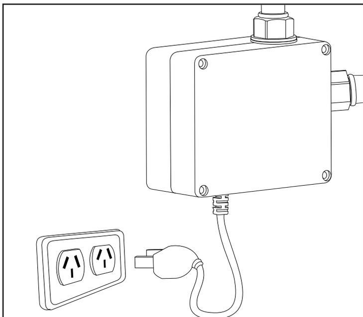
*Nota: El cable de alimentación de este dispositivo de control no puede ser sustituido; si el cable resulta dañado, el dispositivo de control debe ser retirado de su uso.*
