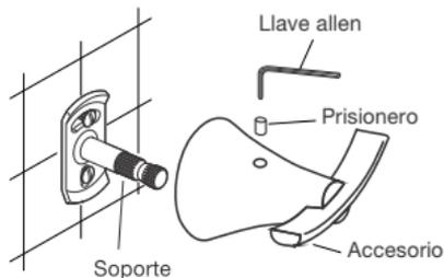
4- Ajuste el accesorio sobre el soporte, como muestra el dibujo.
