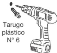
2- Perfore con una mecha  $\varnothing 6$  mm y coloque el tarugo plástico.
