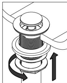
**4.2** Coloque el sello inferior y la arandela, y ajuste la tuerca para fijar el conjunto.
