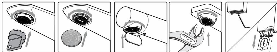
Coloque la herramienta correspondiente según el tipo de aireador que posea y lávelo bajo un chorro de agua. Si esta tapado colóquelo en un vaso de vinagre durante la noche. Al día siguiente vuelva a armarlo.
