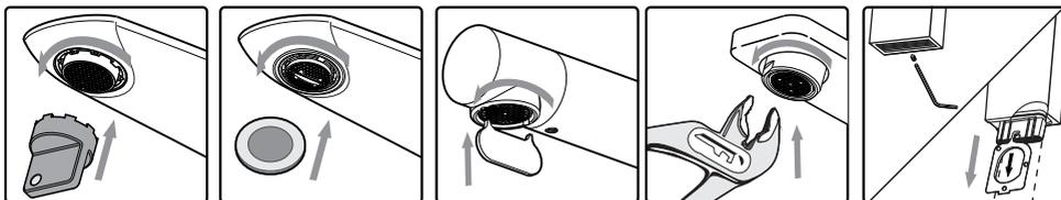
En caso de poseer aireador, utilice la herramienta correspondiente para retirarlo y lávelo bajo un chorro de agua. Si esta tapado, colóquelo en un vaso de vinagre durante la noche. Al día siguiente vuelva a armarlo.
