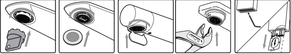
En caso de poseer aireador, utilice la herramienta correspondiente para retirarlo y lávelo bajo un chorro de agua. Si está tapado, colóquelo en un vaso de vinagre durante la noche. Al día siguiente vuelva a armarlo.
