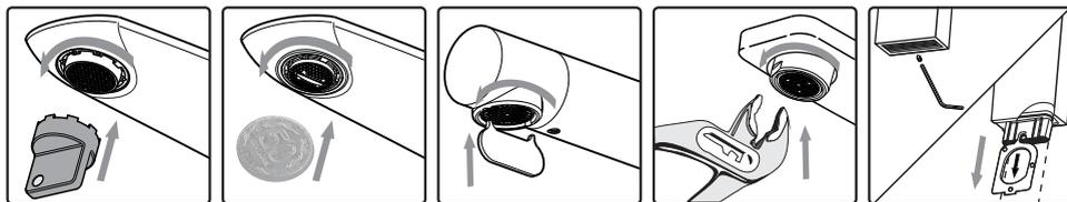
Coloque la herramienta correspondiente según el tipo de aireador y remuévalo del pico. Lávelo bajo un chorro de agua. Si está tapado colóquelo en un vaso de vinagre durante la noche. Al día siguiente vuelva a armarlo.
