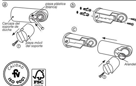
a. Desenrosque el tornillo 1 para poder quitar la pieza móvil del soporte, luego con un destornillador ejerza una leve presión sobre el borde de la pieza plástica (blanca) que se encuentra dentro de la carcasa del soporte de ducha, destrabándola.
