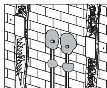
Asegure las cañerías con cemento. Retire la plantilla y cements los codos.
