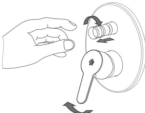
Para derivar la salida de agua hacia la ducha, tire del botón transferencia y girelo en sentido horario 1/4 de vuelta.
