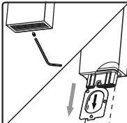
Coloque la herramienta correspondiente según el tipo de aireador y remuevalo del pico. Lávolo bajo un chorro de agua. Si está tapado colóquelo en un vaso de vinagre durante la noche. Al día siguiente vuelva a armarlo.
