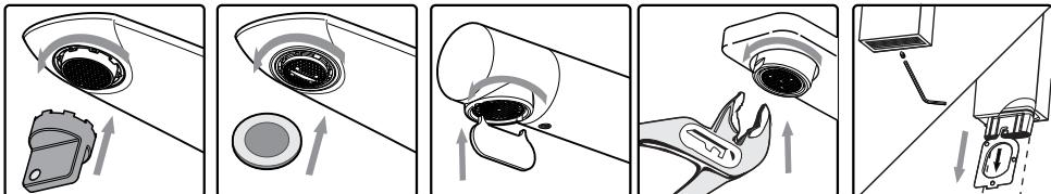
En caso de poseer aireador, utilice la herramienta correspondiente para retirarlo y lávelo bajo un chorro de agua. Si está tapado, colóquelo en un vaso de vinagre durante la noche. Al día siguiente vuelva a armarlo.
