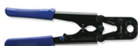
Herramienta manual de cabezal fijo Perfil TH Ø16
